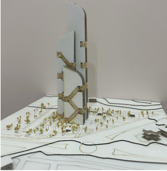
Şekil-3 ve 4. Lazer Kesimi Tamamlanmış Örnek Maket
